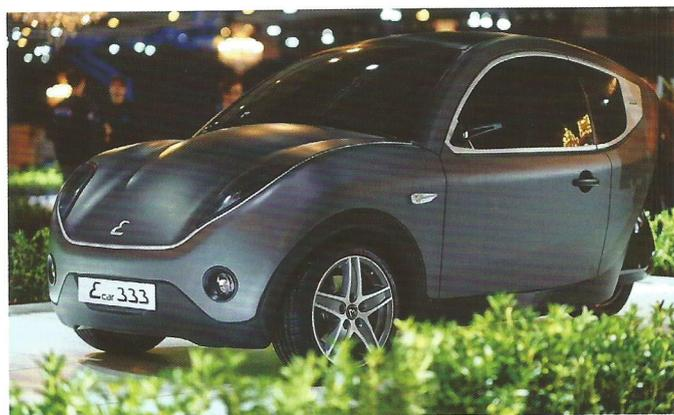
La carrosserie de l'E-Car 333 est en partie composée de lin stratifié. Le châssis est en acier recyclé et le tableau de bord technique en plastique de récupération. « Nous avons développé nous-mêmes notre propre circuit électronique, ce qui nous permettra dans un avenir très proche d'envisager des systèmes de sécurité propres (système anti-endormissement, gestion des distances avec le véhicule avant et arrière, etc.). »
